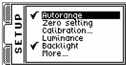
Fig. 5. Configuración del Menú con las opciones seleccionadas: control de rango de medición automático (Auto-rango) y encendido o apagado de la luz trasera.
