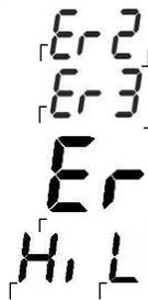
'Er2' se muestra cuando el termómetro está expuesto a rápidos cambios de temperatura ambiente.
