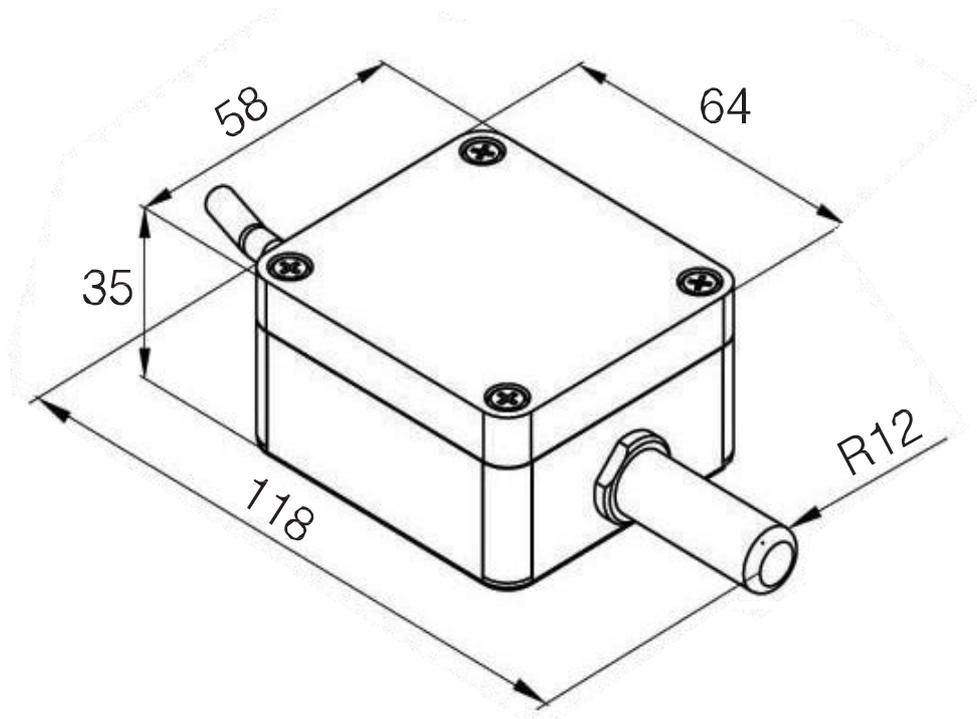
Fig.1. Dimensiones totales del transductor PCE-P18
