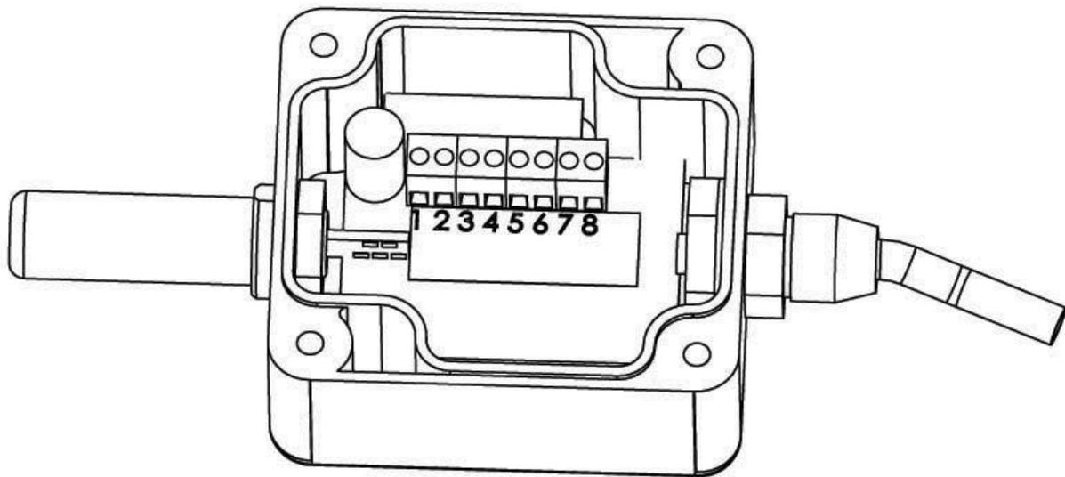
*Fig.3. Marcado de los terminales para la conexión de las señales externas*
