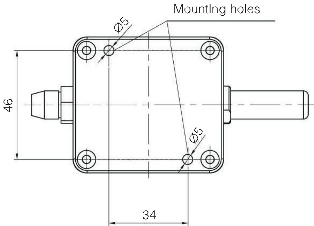
Fig.2. Plano de los agujeros de montaje del transductor PCE-P18
