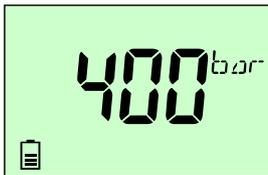
Indicación del rango de Escala Completa (FS)
