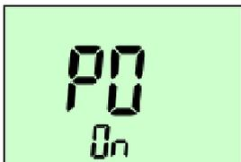
Apagado automático - activada la función se produce después de 15 min. Esta configuración se puede seleccionar dentro del menú.
