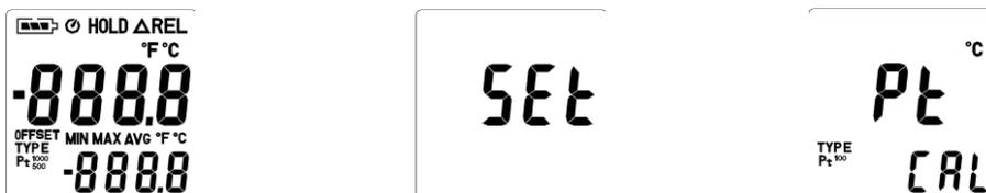
La pantalla ahora muestra „CAL USER“. A continuación presione la tecla „REL“. Se mostrará el valor de medición de la temperatura actual. Cuando presione la tecla para configurar la unidad de temperatura, el valor de medición se configura a cero °C. Ahora se mostrará en la pantalla „SAVE“. La configuración del punto cero ha finalizado.
