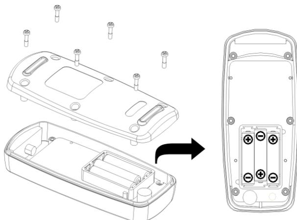
**Importante:** Antes de cerrar el dispositivo de nuevo, compruebe que el anillo de goma este correctamente colocado o dañado. Si el anillo de goma está dañado o no está colocado correctamente, puede entrar agua y causar daños en el dispositivo.
