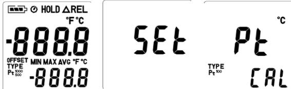
Se mostrará en la pantalla „CAL USER“. A continuación mantenga presionada la tecla de la retroiluminación de fondo. Ahora se mostrará en la pantalla „CAL REST“. A continuación presione la tecla para configurar la unidad para reiniciar el dispositivo. Ahora se mostrará en la pantalla „SURE REST“. Utilice la tecla para configurar la unidad para confirmar los cambios.
