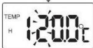
Paso 2. Vuelva a presionar y mantener presionada la tecla **MODE**, como indicado en el paso 1. Siga el procedimiento hasta que las decenas indiquen el número 2. Entonces deje de presionar.
