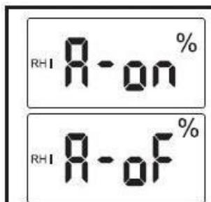
Presione **MODE** para seleccionar Hi RH, alarma ON o alarma OFF.
