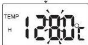
Paso 3. Vuelva a presionar y mantener presionada la tecla **MODE**, como indicado en el paso 1. Siga el procedimiento hasta que las unidades indiquen el número 8. Entonces deje de presionar.
