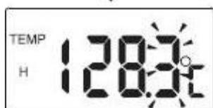
Paso 4. Vuelva a presionar y mantener presionada la tecla **MODE**, como indicado en el paso 1. Siga el procedimiento hasta que los decimales indiquen el número 3. Entonces deje de presionar.
