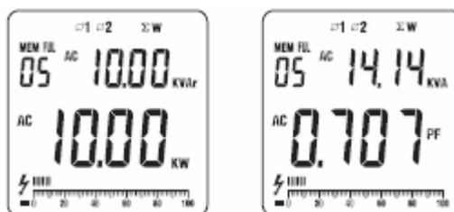
6. La máxima potencia de una fase (Fase Simple), es de 600 kW, aparecerá el símbolo OL cuando la medición sobrepasa este límite para una sola fase. El máximo rango de medida de potencia activa de las 3 fases es de 1800 kW, aparecerá el símbolo OL cuando la medición sobrepasa este límite para las 3 fases.
