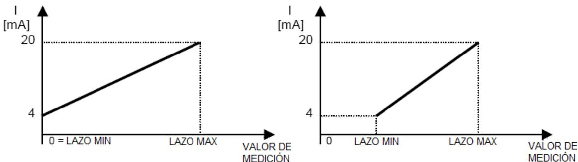
¡Atención!!! ¡- si la unidad de medida es cambiada por el usuario, después el valor mínimo del lazo se reajusta a cero! Si el valor de la unidad medida es menor que valor mínimo, la corriente del lazo es DE 3,75mA.
