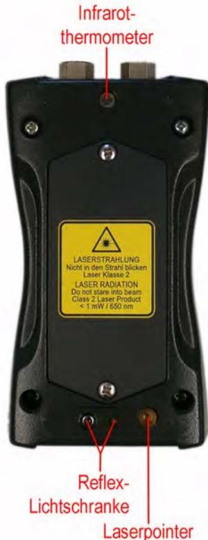
Imagen 34: Sensor de revolución y temperatura, puntero láser
