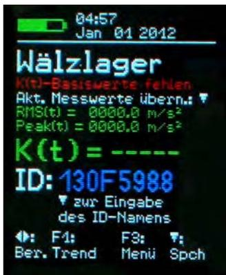
Imagen 27: Modo de funcionamiento K(t) con nuevo VMID
