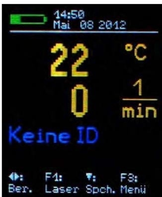
Imagen 34: Indicador de revoluciones y temperatura
