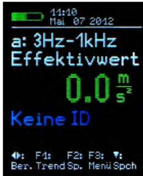
Imagen 18: Indicador del valor efectivo de medición
