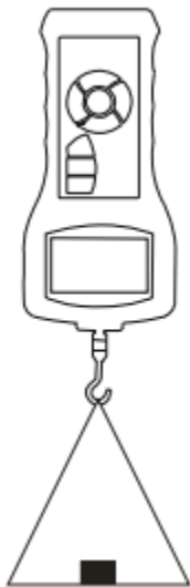
Medición utilizando un medidor portátil (sólo hasta 200N)
