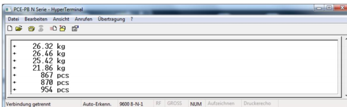
**10.2.3 - STAb** Con este ajuste los datos se envían sólo cuando el valor pesado se ha estabilizado (observe el símbolo de estabilidad en la pantalla).
