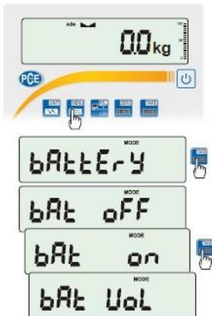
La función *bAttErY* permite activar o desactivar la carga de los acumuladores durante el trabajo con el alimentador y controlar su nivel de carga.
