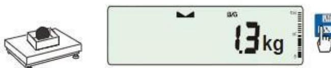
Para leer el peso bruto, pulse la tecla
