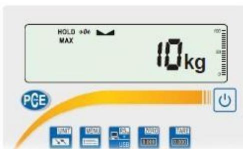
Antes de la medición, la balanza debería tararse.
