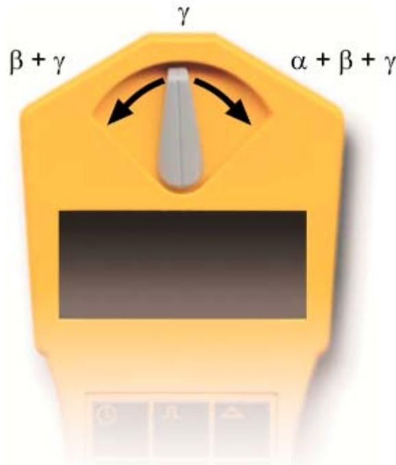
Dentro de su funcionamiento estándar, el GAMMA SCOUT® le informa de manera rápida y segura de la carga radioactiva actual. La así denominada dosis equivalente se calcula en la actualidad con el factor de 95,00 [impulsos por minuto /  $\mu$ Sv por hora] de los impulsos determinados por tiempo, factor válido para el rango de medición del GAMMA SCOUT®
